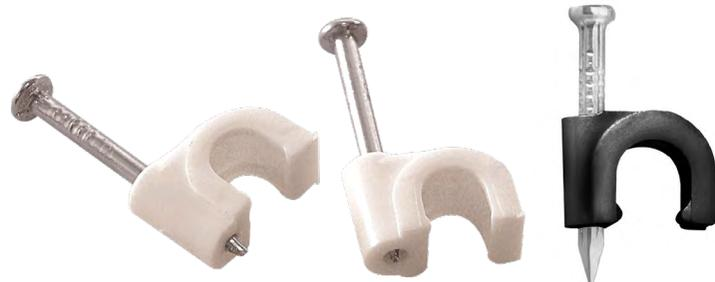
O **Fixa-Fio COAXIAL** é constituído do conjunto de prego de aço temperado mais o suporte plástico chamado de fixa-fio, formando o conjunto para a fixação dos respectivos cabos coaxiais. Pode ser aplicado na fixação do cabo no rodapé ou na parede, através do golpeamento do prego com o uso de um marte-
