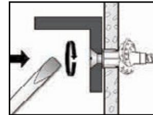
Dê o devido torque e conclua a fixação.
